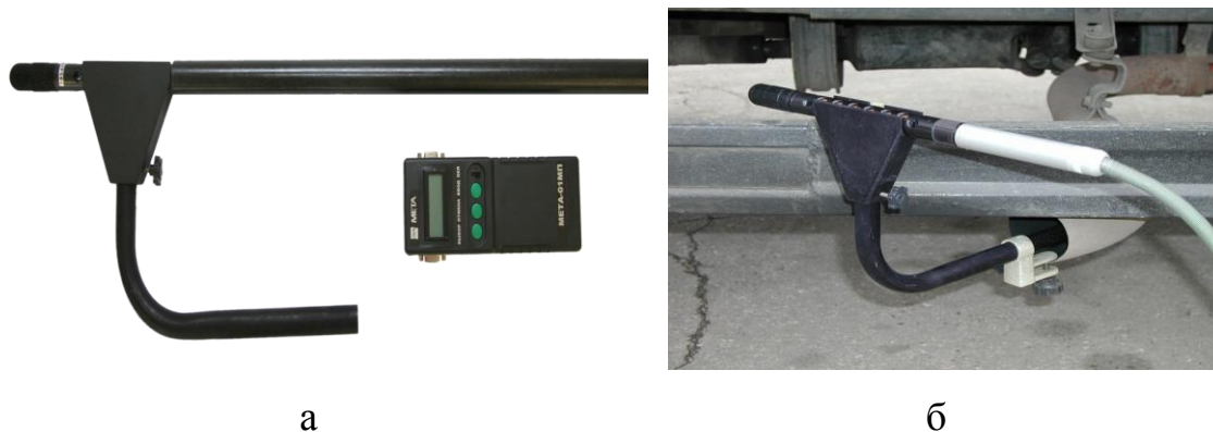
Рис.2.12. Внешний вид (а) и пример использования (б) дымомера типа «Мета»
