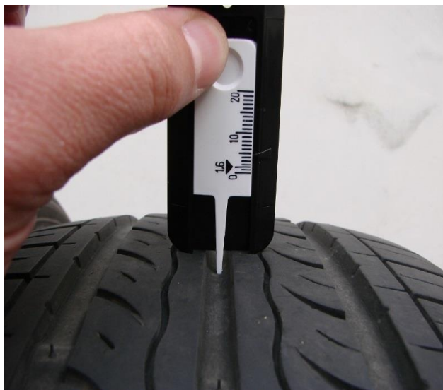
Рис.2.9. Пример использования устройства для измерения остаточной высоты протектора шины
